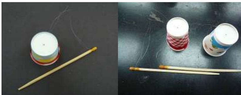
圖 10 將釣魚線之圓圈小結套進去竹筷子之松膠的凹槽上
